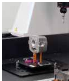
K551218: Toepassing van het palletsysteem van de onderste ontvanger
